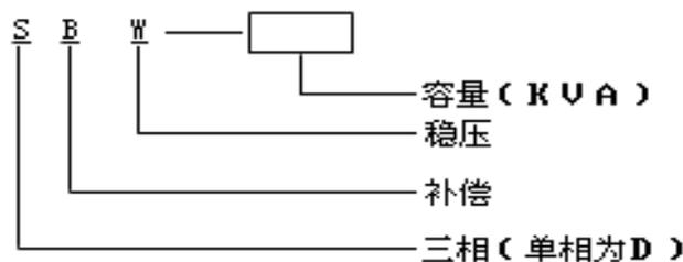
**稳压范围：**是指保证稳压器输出电压在精度允许范围内输入电压的变化范围。通常稳压范围为 304—456V，即输入电压的变化范围为正负 20%。
